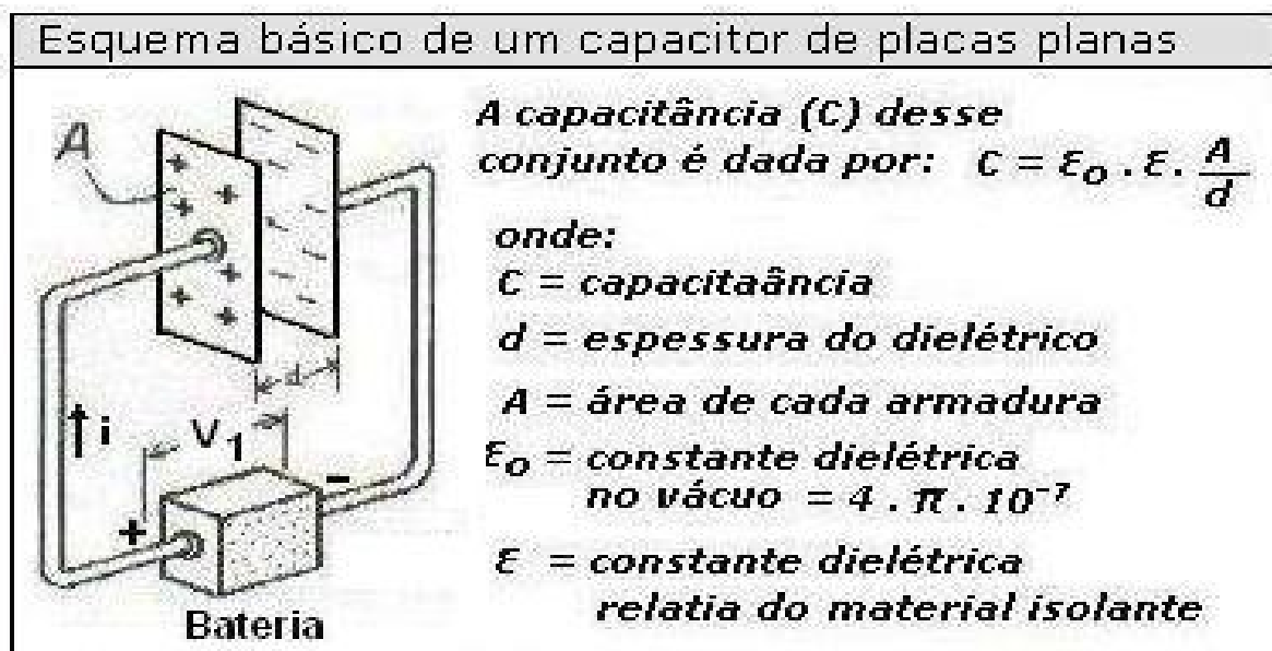
Figura 1 - Esquema básico de um capacitor de placas planas paralelas
