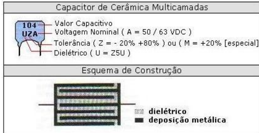
Figura 11 - Capacitor de cerâmica multicamadas
