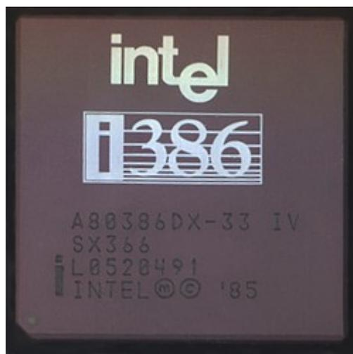
**Figura 25** – [UCP](#) Intel i386 DX de 33 MHz.
