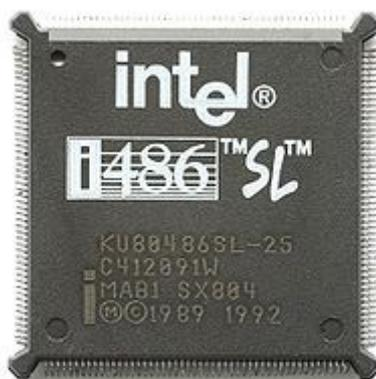
**Figura 27** – Foto de um microprocessador 486 SL.
