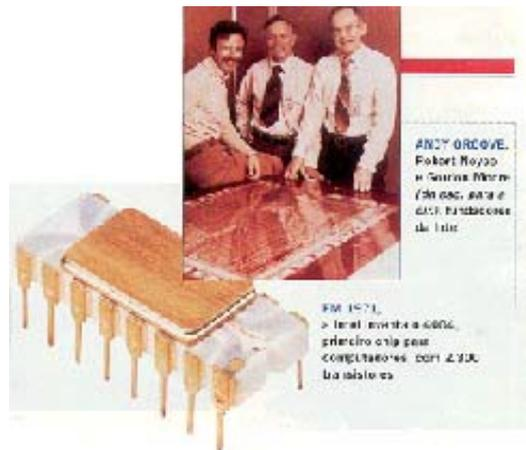
**Figura 19 – O primeiro chip da Intel, o 4004 com 2.300 transistores.**
