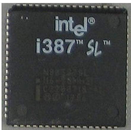
**Figura 26** – O Intel 80387SL, coprocessor para o i386SL.
